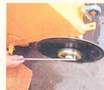
新型フランジを使用した写真。遠心力が有効に活用されて無駄な水撥ねが全くない
