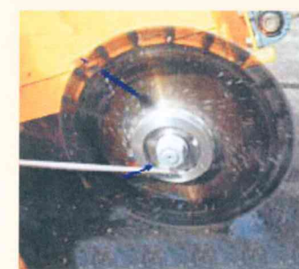
従来の標準フランジを使用した写真。水の飛散が多く、側面も撥ねがある
